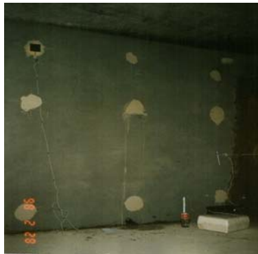
Рисунок 7 – Схема измерения плотности теплового потока
