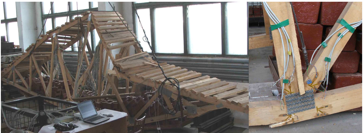
Рисунок 12 – Разрушение фермы и нижнего приопорного узла
