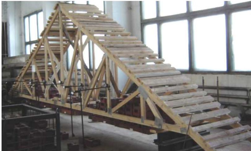
Рисунок 8 – Испытание деревянных ферм с консольными свесами пролетом 7,6 м
